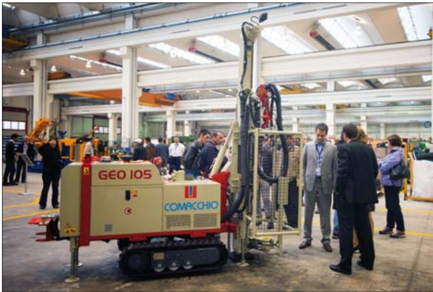
La perforatrice verticale GEO 105, destinata al settore delle indagini geognostiche
