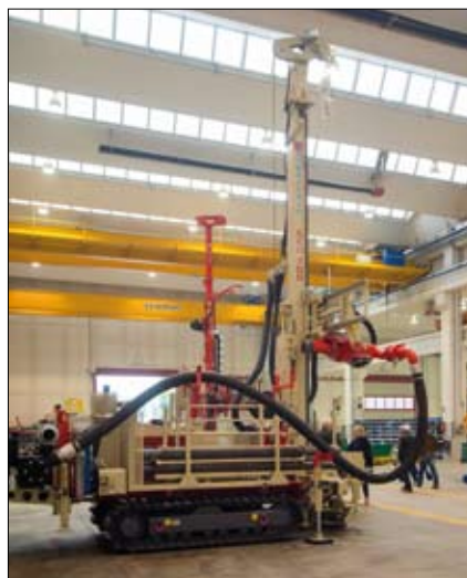
Tra le macchine esposte durante l'Open House, anche la MC 600 P con testa di rotazione vibrante da 1.100 daNm e la nuova perforatrice GEO 700
